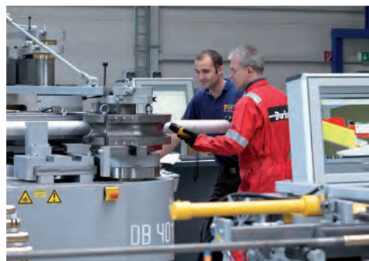
Maschinenvorbereitung für den Biegeprozess
