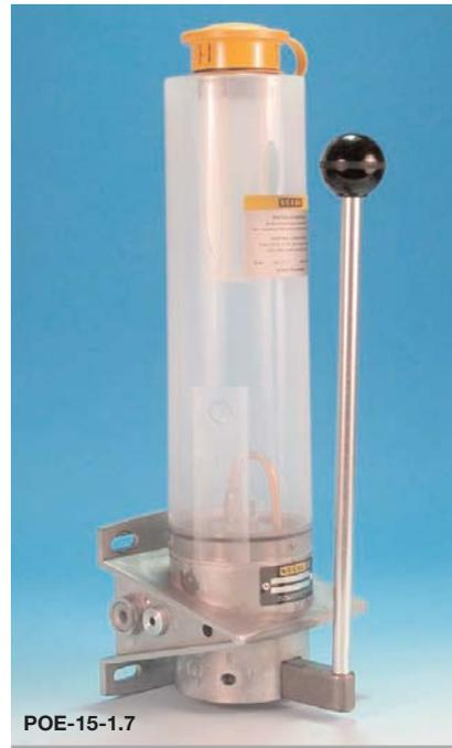
Diese manuell oder pneumatisch betätigten Einkolbenpumpen sind für intermittierend betriebene Einleitungs-Zentral-schmieranlagen mit Kolbenverteilern entwickelt worden. Sie enthalten den für die Druckentlastung und Druckbegrenzung erforderlichen Ventilsatz.
