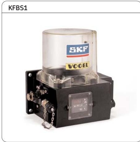
Für das Pumpenaggregat **KFBS** erfolgt die Steuerung durch das integrierte Steuer- und Überwachungsgerät IG502-I, sie kann zeit- oder (impuls-) lastabhängig erfolgen, wahlweise mit oder ohne Überwachung des Druckaufbaus in der Anlage. Hierzu muss in der Anlage ein Druckschalter<sup>1)</sup> montiert sein.
