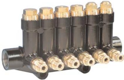
Die Verteiler übernehmen die Verteilung und Dosierung des von der Pumpe geförderten Schmierstoffes an den einzelnen Schmierstellen unabhängig voneinander.
