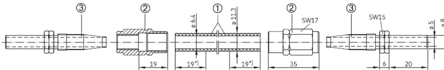
\*) Einschraublänge bei Festlegung der Schlauchlänge 2x berücksichtigen.
