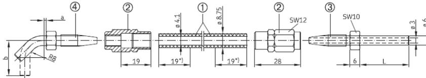
\*) Einschraublänge bei Festlegung der Schlauchlänge 2x berücksichtigen.
