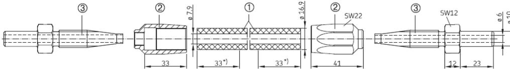
\*) Einschraublänge bei Festlegung der Schlauchlänge 2x berücksichtigen.
