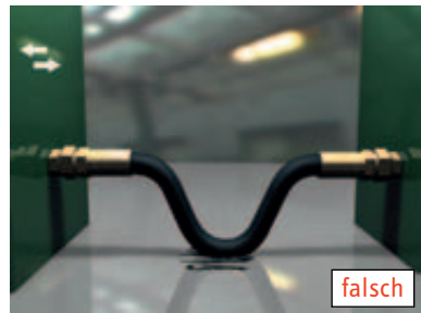
Abbildung 9: Vermeidung von Abrieb durch ausreichende Bewegungsfreiheit
