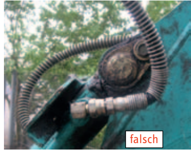
Abbildung 8: richtig – Gerader Abschnitt mit 1,5 d_a vor Biegung falsch – Eine Schlauchscheuerschutzspirale stellt keinen Knickschutz dar
