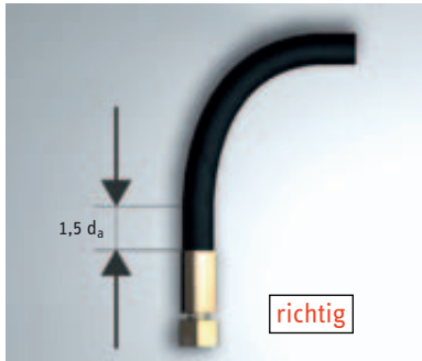
Abbildung 8: richtig – Gerader Abschnitt mit 1,5 d_a vor Biegung falsch – Eine Schlauchscheuerschutzspirale stellt keinen Knickschutz dar
