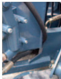
Abbildung 9: Vermeidung von Abrieb durch ausreichende Bewegungsfreiheit
