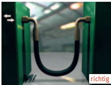
Abbildung 9: Vermeidung von Abrieb durch ausreichende Bewegungsfreiheit
