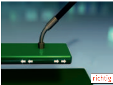
Abbildung 15: Verlegung bei Schwingungen
