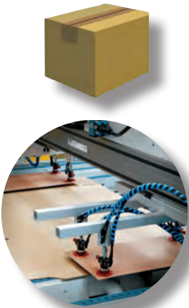
Linearmotorgetriebener Funktionseinleger einer Faltschachtelmaschine
