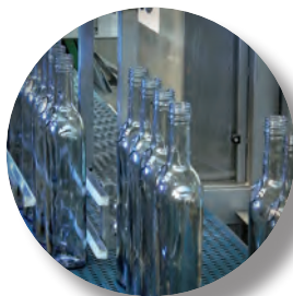
Synchronweiche für Flaschenförderung
