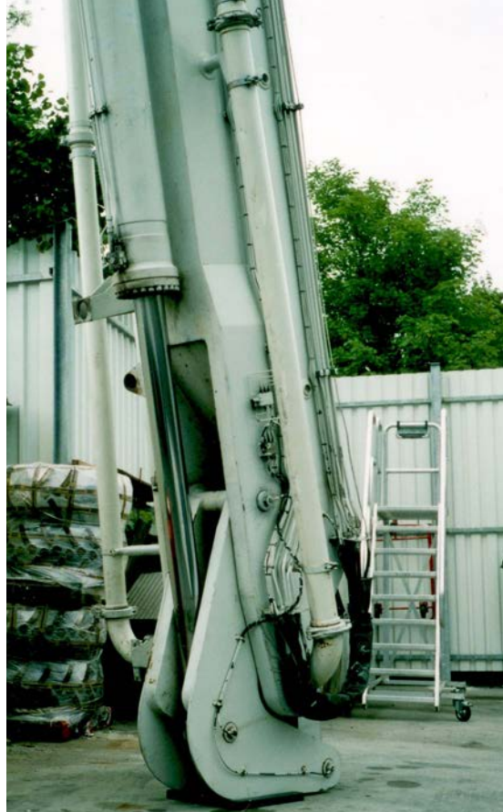
Abb. 38 Auf den Boden abgesenkter Ausleger einer Betonpumpe
