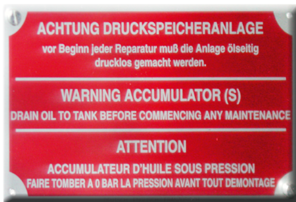
Abb. 21 Warnhinweis an Druckspeicheranlage
