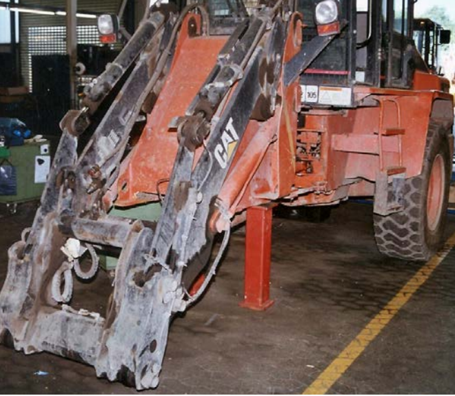
Abb. 33 Unterbaugestell bei Arbeiten am Radlader
