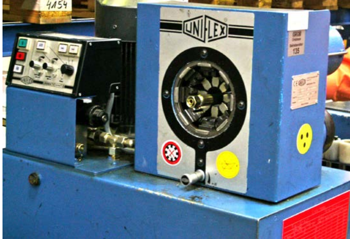
Abb. 14 Vorrichtung zum Verpressen von Schlaucharmaturen
