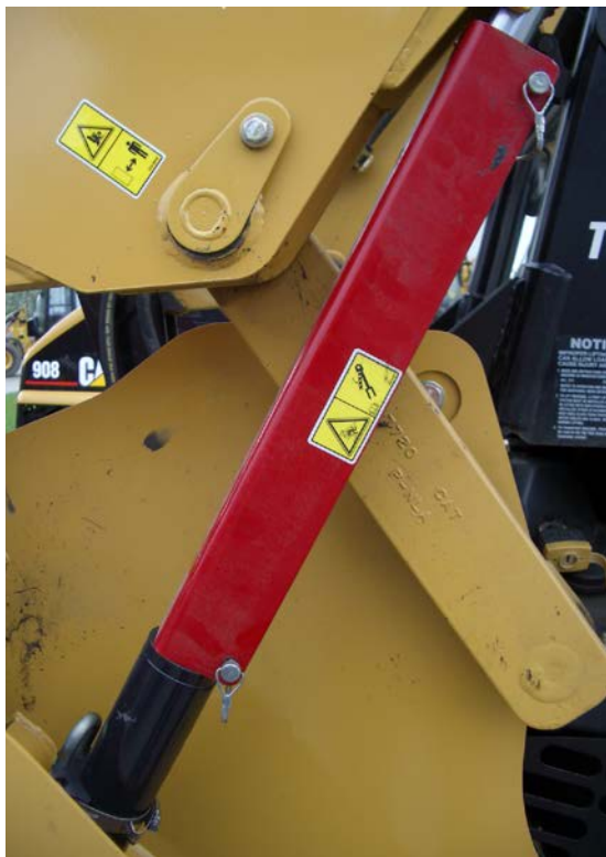
Abb. 41 Stützeinrichtung in Position an einer Erdbaumaschine
