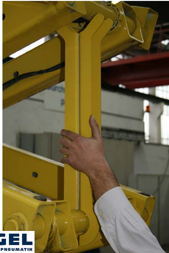
Abb. 29 Eingelegte Wartungsstütze an hydraulischer Scheren-Hubarbeitsbühne
