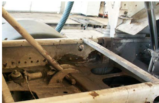
Abb. 37 Sicherungsstütze an einem hydraulisch angehobenen Fahrzeugaufbau
