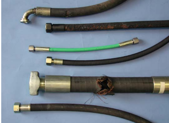
Abb. 16 Beispiele ausgefallener Hydraulik- Schlauchleitungen
