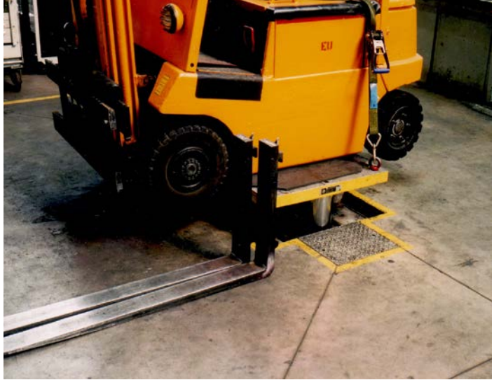
Abb. 35 Demontierte Hubga- beln bei Arbeiten an der Staplerhydraulik
