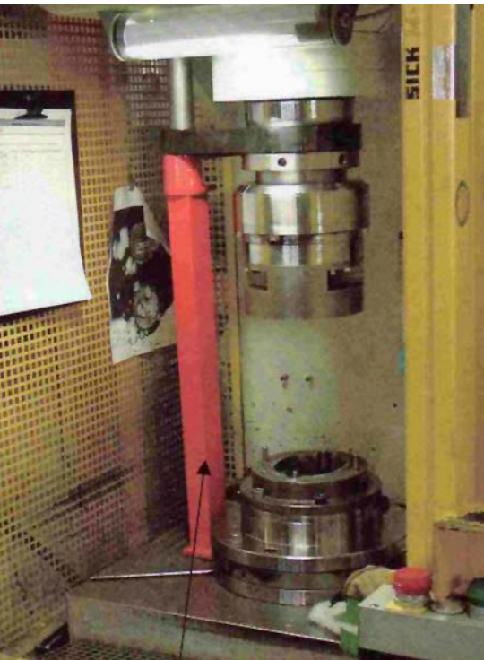
Abb. 28 Eingesetzte Abstützung an einer hydraulischen Presse
