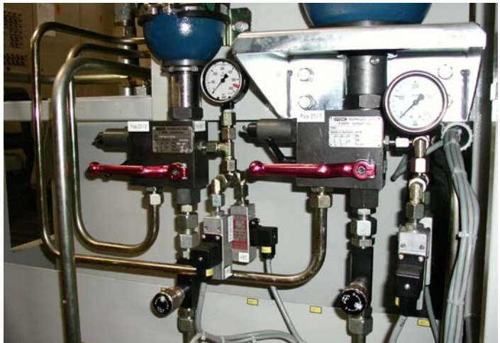
Abb. 25 Druckentlastete Hydrospeicher mit abgesperrten Druckleitungen
