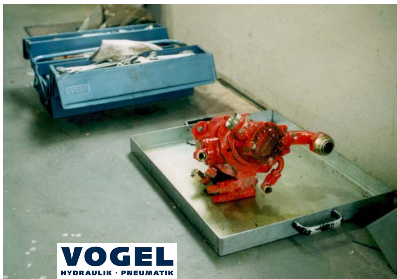
Abb. 19 Mobilhydraulik- pumpe in einer Ölauffangwanne
