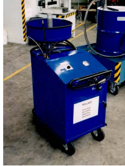
Abb. 34 Hilfsgerät zur Entsorgung von alter Druckflüssigkeit
