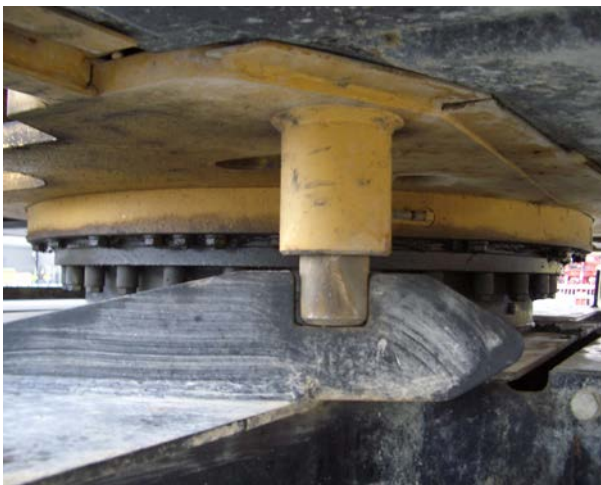
Abb. 40 Dreh Sperre an einem Hydraulikbagger in Sperrstellung
