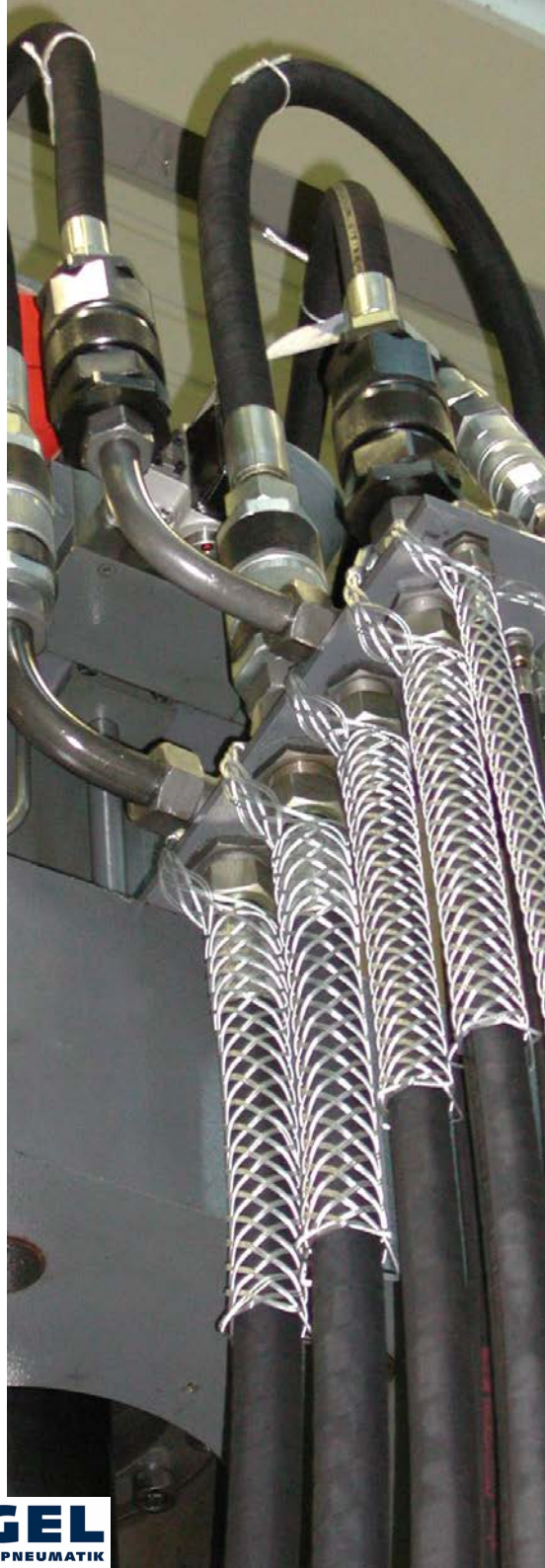
Abb. 17 Ausreissicherungen an Schlauchleitungen
