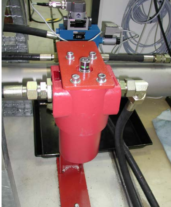
Abb. 23 Hydraulikfilter mit Verschmutzungsanzeige
