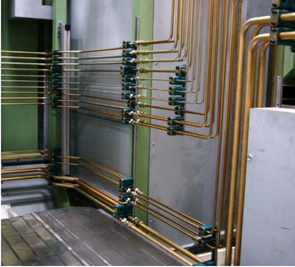
Abb. 10 Fachgerechte Befestigung von Rohrleitungen mit Leitungshalterungen
