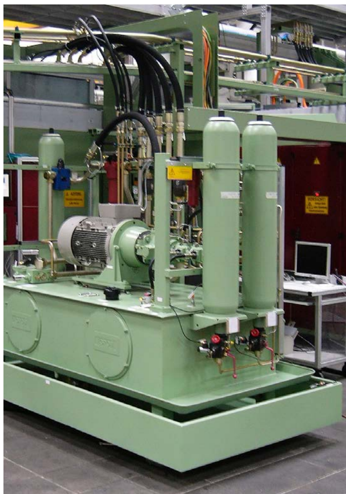
Abb. 24 Hydraulikaggre- gat an stationärer Produktionseinrichtung
