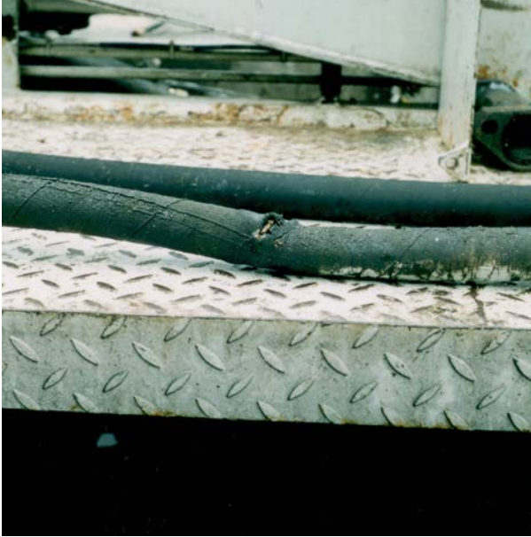
Abb. 2 Geborstene Hydraulik- Schlauchleitung
