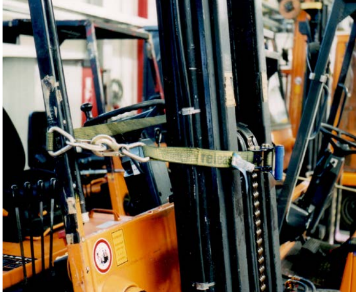
Abb. 36 Festgezurrtes Hubgerüst bei Arbeiten an Neigezylindern
